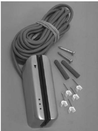
Le format de dialogue est de l'ISO II. Il ne peut être connecté directement sur un contrôleur ATS1250. Pour cela il suffit d'utiliser un convertisseur « Format ISO → Format Wiegand 32 bits ».
