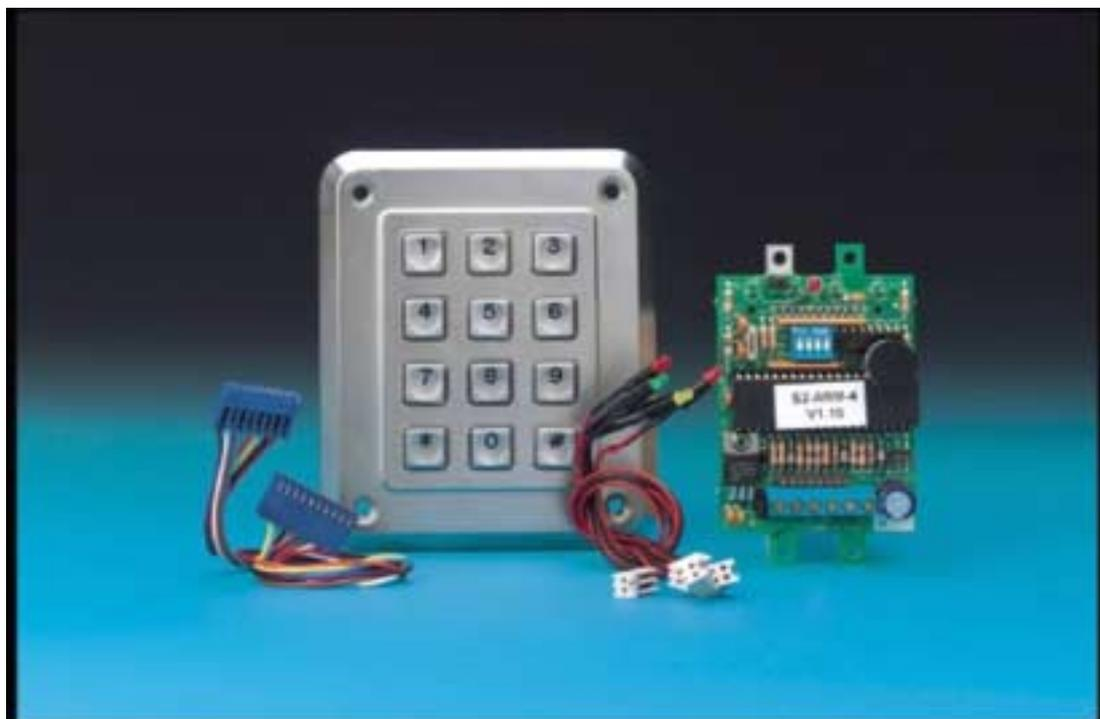
L'unité est fournie sous forme de kit (voir photo ci-dessus), comprenant un clavier et une électronique séparée, sur laquelle les raccordements sont effectués. Le clavier est relié à la carte électronique par une nappe souple. 4 voyants (2 rouges, 1 vert et 1 jaune) sont fournis.
